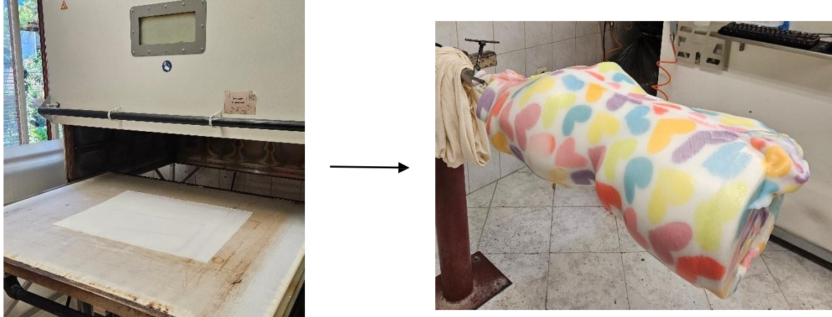
Slika 19 : Proces grijanja plastike u peći i aplikacija na model
