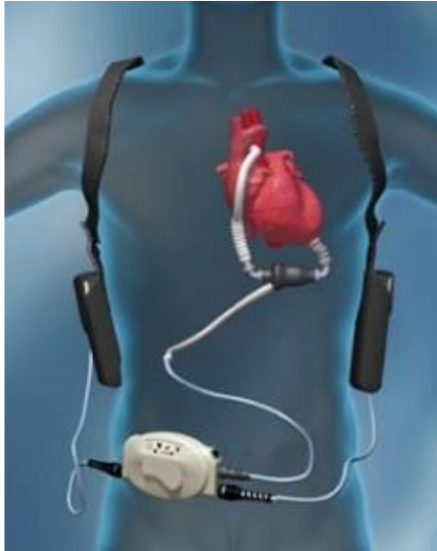
Slika 3. Implantabilni uređaj za mehaničku cirkulacijsku potporu
