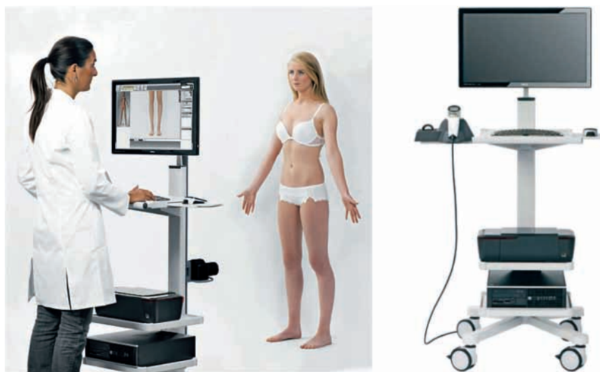
Uređaj za potpuno automatizirano „mapiranje“ kože cijeloga tijela.
