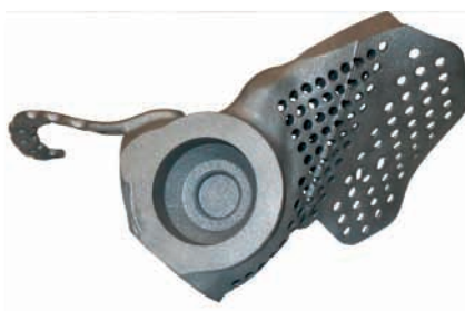
Personalizirani implantat zdjelice izrađen od titana na SLS printeru.
