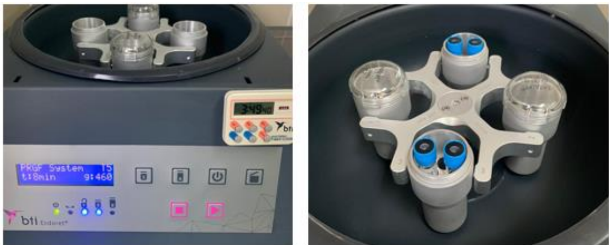
Slika 7. Aparat za centrifugiranje
