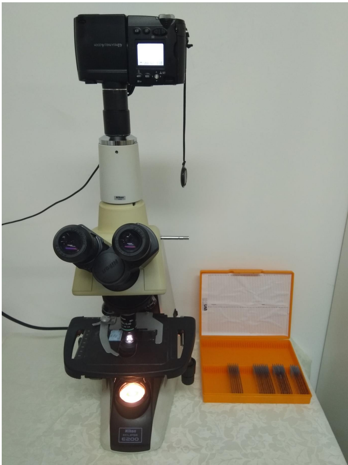
Slika 24 – Mikroskop Nikon ECLIPSE E200 te digitalni fotoaparat Nikon E4500 (Izvorna slika)
