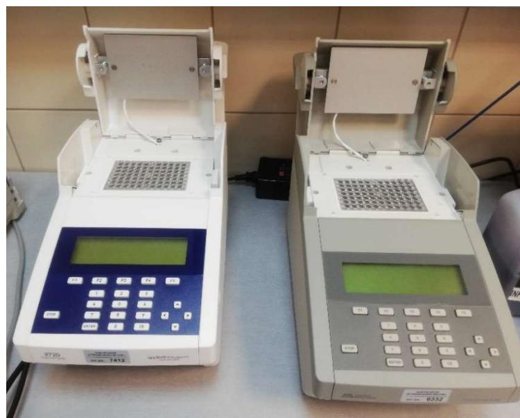
Slika 8. Uredaji AB PCR 2720 i 2700, thermal cycler (Applied Biosystems, SAD) za PCR-SSP genotipizaciju (slikano u HZTM)
