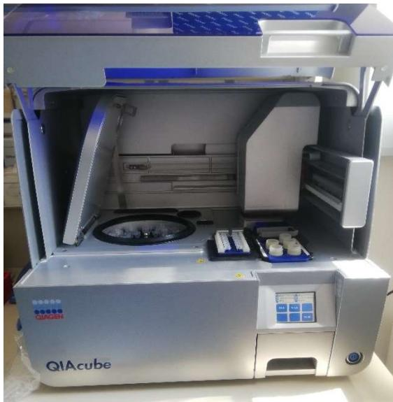
Slika 6. a) QIAcube uređaj za izolaciju DNA
