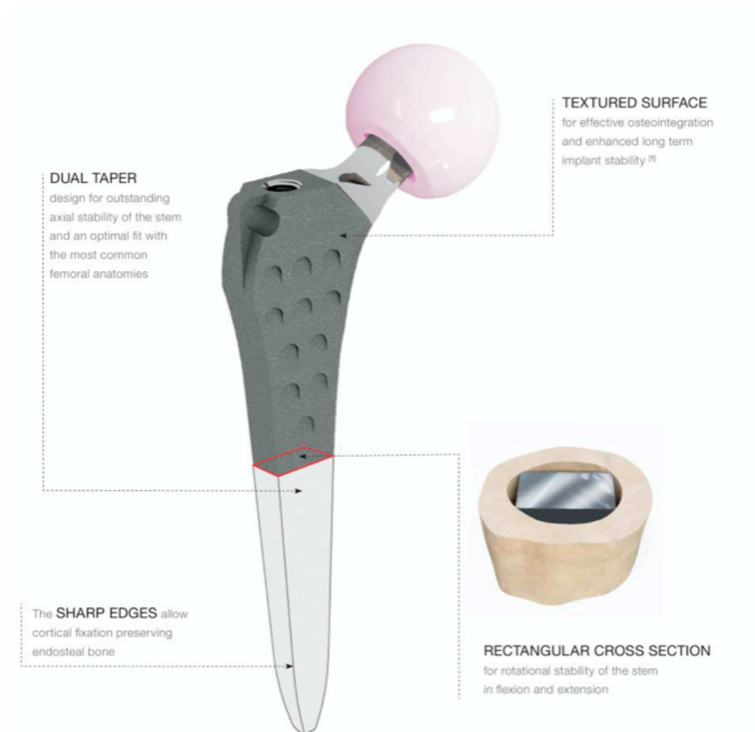
Slika 7. Crtež femoralnoga stema endoproteze kuka – model Zweymüller i presjeka kosti dijafize femura s implantiranim stemom (Lima C2); (izvor fotografije LimaCorporate, Udine, Italija, uz dopuštenje https://limacorporate.com )
