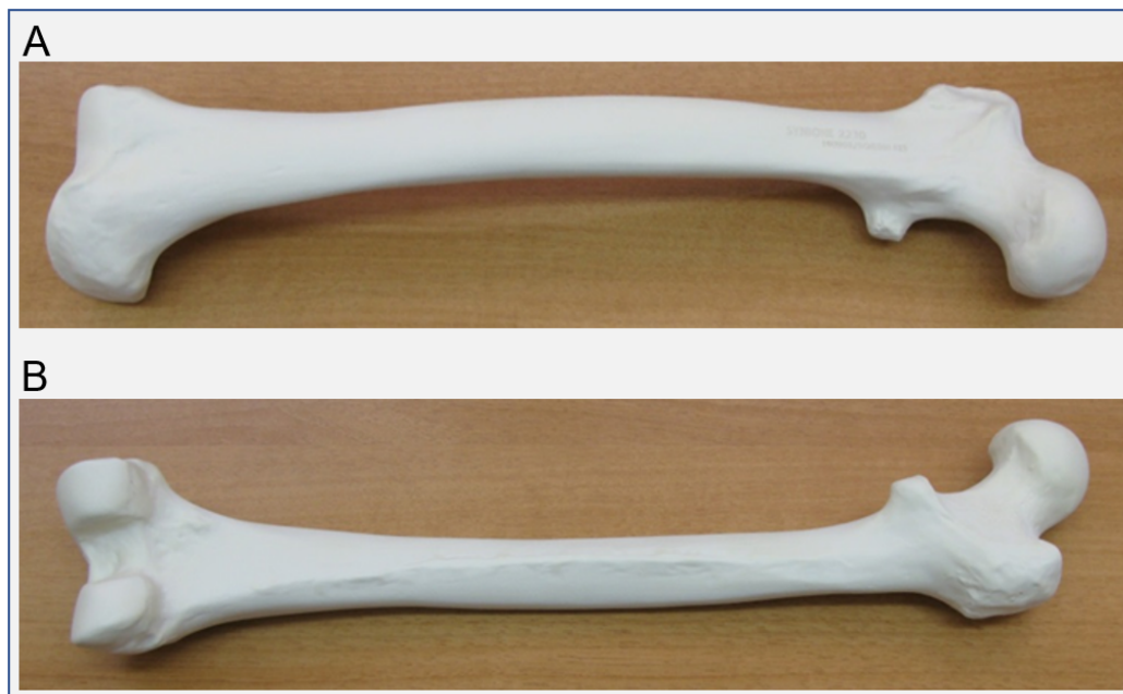
Slika 21. Model desnoga umjetnoga femura četvrte generacije koji je po svojim svojstvima sličan ljudskome femuru (Synbone, Švicarska) s prednje (A) i stražnje (B) strane koji se koristio u statičkim i cikličkim istraživanjima
