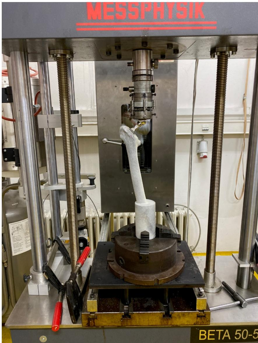
**Slika 22.** Femoralna komponenta endoproteze kuka tipa Zweymüller ugrađena u model umjetne kosti pri statičkom ispitivanju; za statičko ispitivanje uzoraka koristila se statička kidalica (Beta 50-5, Messphysik, Austrija), a uzorci su se ispitivati do loma
