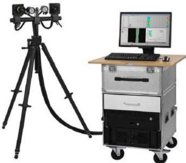
Slika 28. Optički mjerni sustav Aramis 4M (98)
