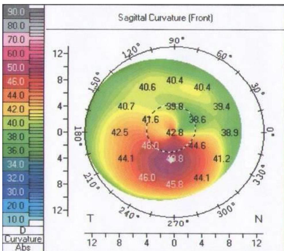
Slika 4. Karakterističan nalaz keratokonusa snimljen kornealnom topografijom na principu Scheimpflug tehnologije (Pentacam, Oculus Inc., Duttenhofen, Germany)
