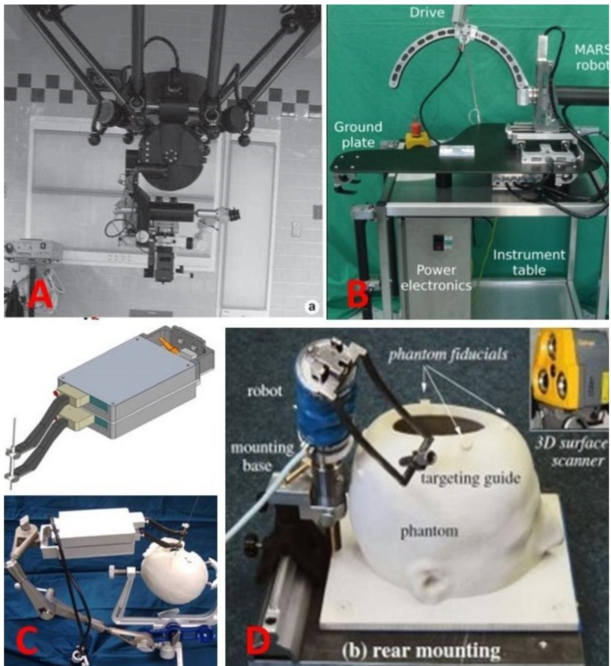
Slika 4. Konstrukcijska rješenja nekih od prvih robotskih sustava koji se koriste i danas u stereotaktičkoj neurokirurgiji a) Surgiscope, b) MARS robot, c) iSys1 robot, d) robot konstruiran od Shoham i sur. (slike dostupne na stranicama proizvođača)
