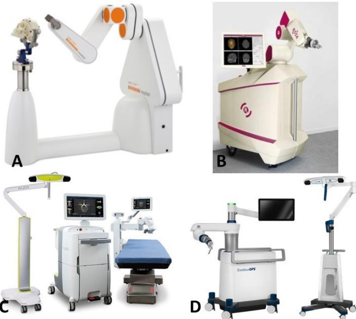
**Slika 5.** Najznačajniji komercijalni robotski sustavi koji se danas koriste u kliničkoj praksi. a) Neuromate, b) Rosa, c) Mazor, d) Excelsisus GPS (slike dostupne na komercijalnim stranicama proizvođača)
