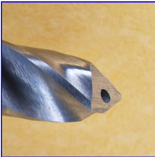
Slika 62. Oštrica prvog stupnja dvostupnjevanog spiralnog svrdla promjera 3.4-4.5 mm prije mjerenja
