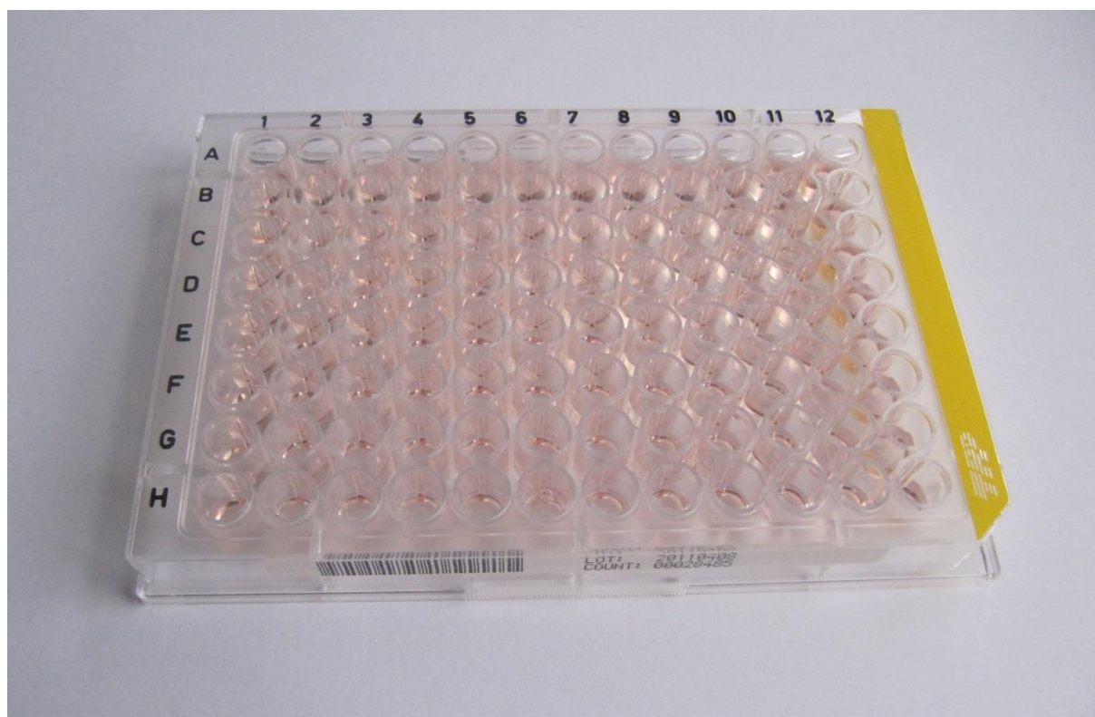
Slika 11. Mikrotitarska pločica za testiranje antimikrobne osjetljivosti klamidijских sojeva sa suspenzijom McCoy stanica (Izvor: Odsjek za klamidije, Služba za mikrobiologiju, HZJZ)
