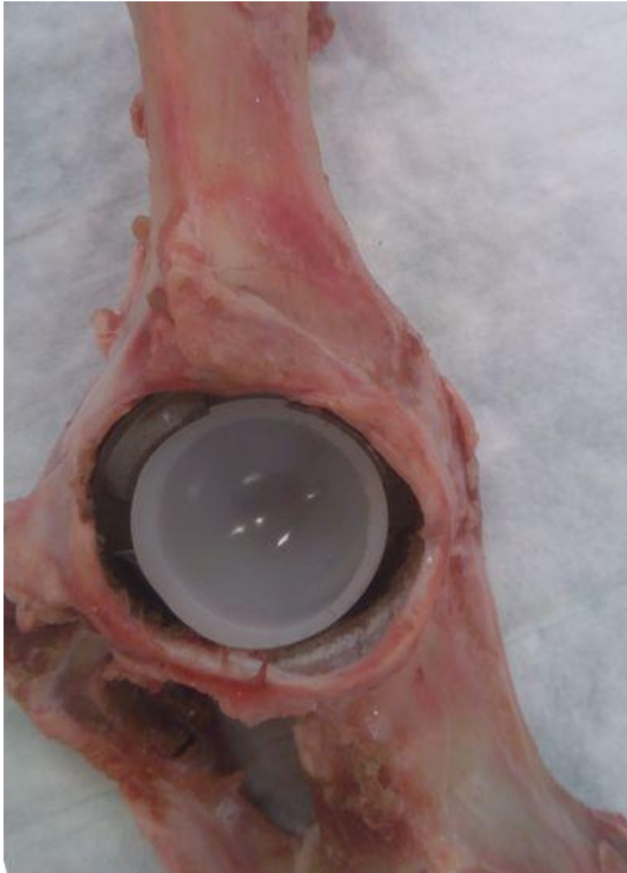
Slika 23. Pomak acetabularne komponente u dubinu uslijed opterećenja.
