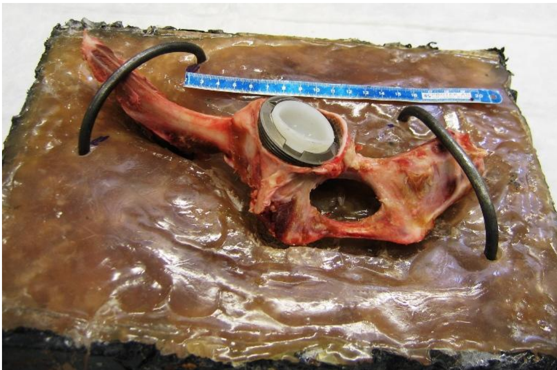
Slika 21. Zdjelica fiksirana na posebno izrađeni držač.
