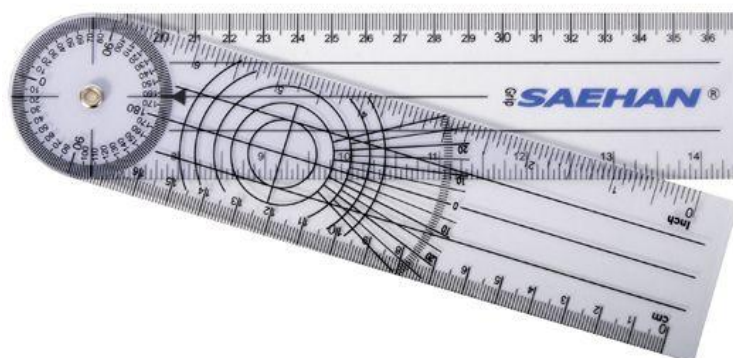
Slika 20. Kutomjer za određivanje točnog položaja acetabularne komponente endoproteze kuka (45 stupnjeva inklinacije i 20 stupnjeva anteverzije).
