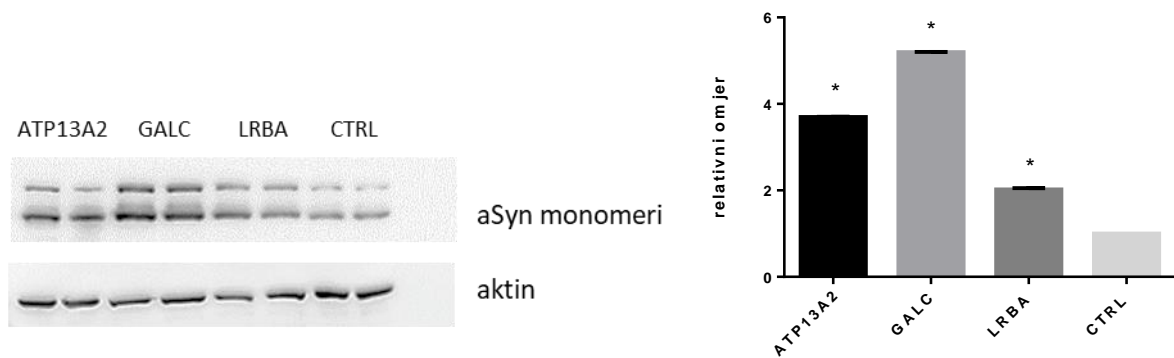
Slika 5.11. Prikaz ekspresije aSyn monomera Western blot metodom. Nakon utišavanja LRBA , ATP13A2 i GALC gena metodom lentiviralne transdukcije gena shRNA stanice su pokupljene, priređeni su stanični lizati te je 10\mu\text{g} proteina od svake stanične linije u duplikatu nanijet na 15% SDS-PAGE gel. Kako bismo potvrdili da je u svim uzorcima nanosena jednaka količina proteina, sve membrane su naknadno inkubirane s protutijelom za \beta -aktin. Denzitometrijom je utvrđen omjer intenziteta signala stanica transduciranih shRNA za ciljni gen ( ATP13A2 , GALC i LRBA ) i kontrolnom shRNA (CTRL) te je izražen u relativnim jedinicama.
