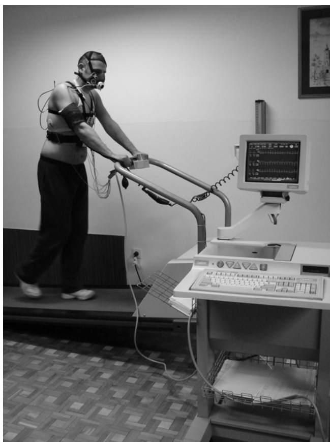
Slika 1. Mjerenje funkcionalne sposobnosti kardiorespiratornog sustava pomoću direktne spiroergometrijske metode pomoću mobilnog 'breath-by-breath' uređaja Cosmed quark K4b 2 (Cosmed, Rim, Italija)
