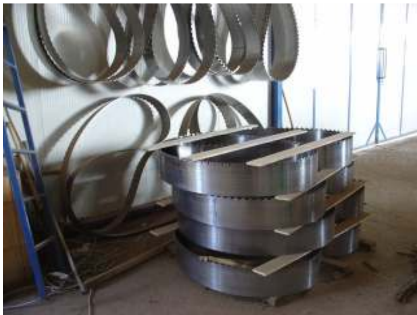
Slika 3. List tračne pile – oštrica iz nelegiranog ili niskolegiranog čelika
