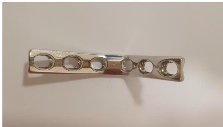
**Slika 41.** Pločica broj 13 iz druge skupine prikazana sprijeda (pH 6,0) po statickom opterećenju
