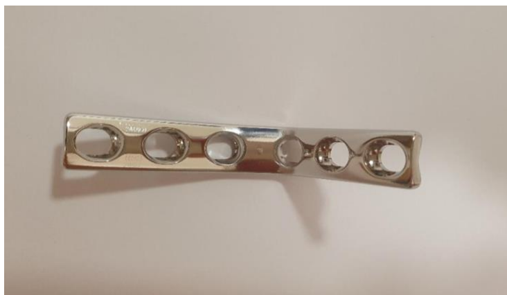
Slika 41. Pločica broj 13 iz druge skupine prikazana sprijeda (pH 6,0) po statičkom opterećenju
