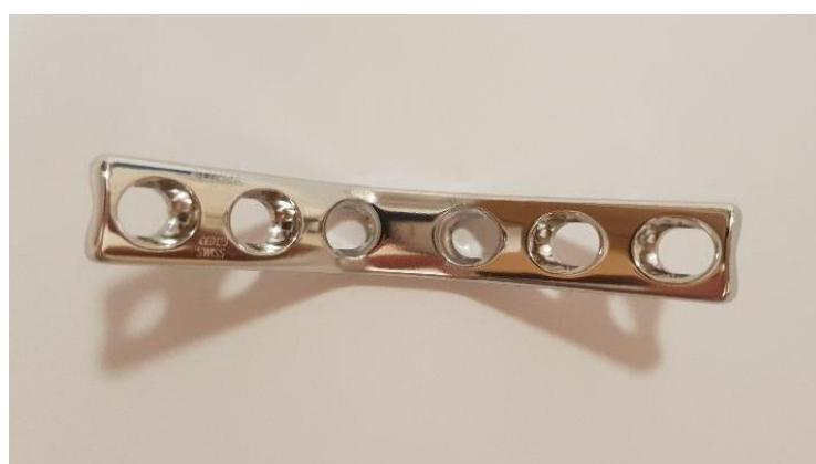
**Slika 43.** Pločica broj 35 iz treće skupine prikazana sprijeda (pH 5,0) po statickom opterećenju
