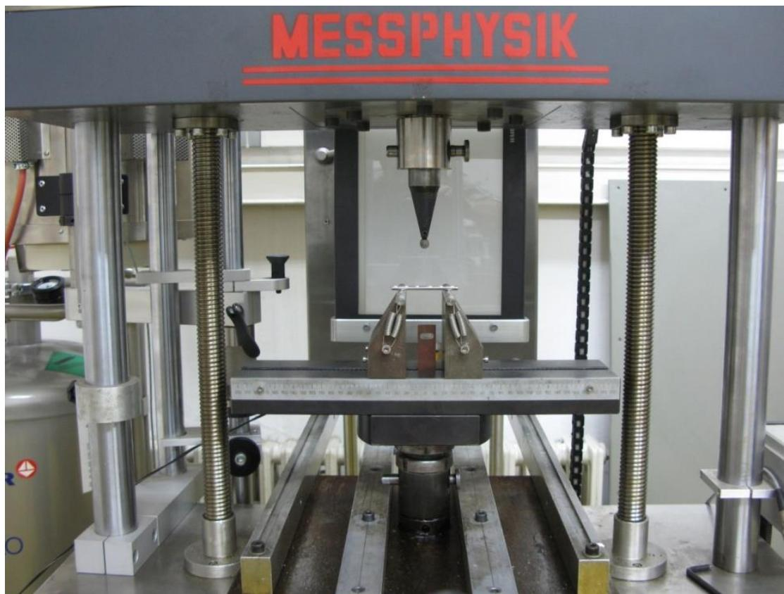
Slika 14. Eksperimentalni postav kod statickog savijanja pločica u tri točke
