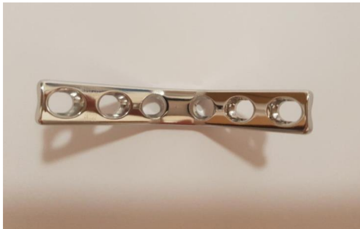
Slika 39. Pločica broj 12 iz prve skupine prikazana sprijeda (pH 7,0) po statičkom opterećenju
