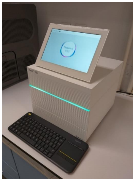
Slika 15. iSeq 100 System platforma na kojoj je učinjeno sekvenciranje.
