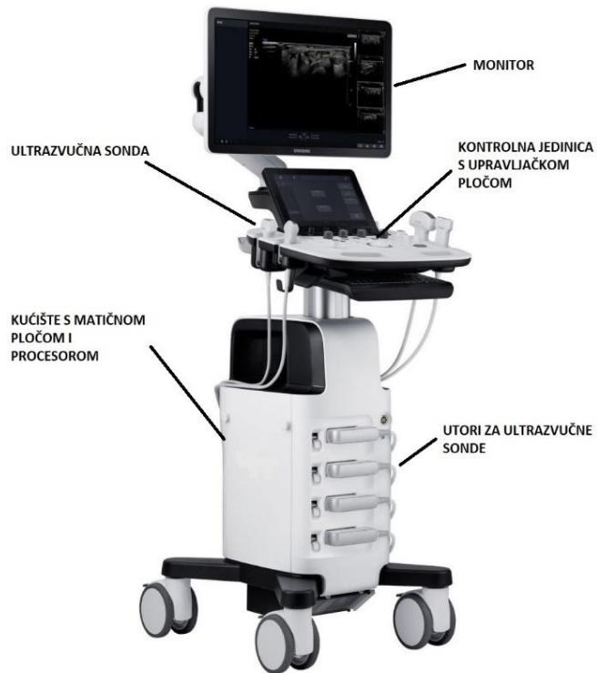
Slika 1. Prikaz ultrazvučnog uređaja sa osnovnim komponentama
