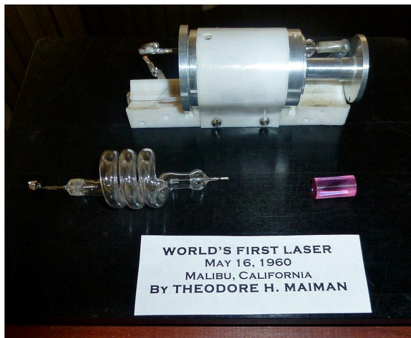
Slika 1 Prvi laser, konstruirao Theodore Maiman 1960. godine (dostupno na: https://commons.wikimedia.org/wiki/File:World%27s_first_laser_out_of_case.jpg , pristupljeno 23.04.2023.)
