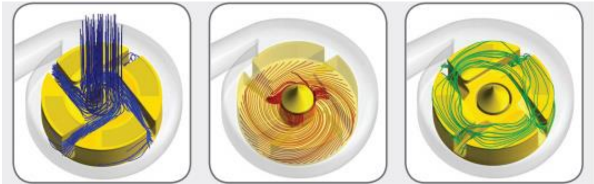
SLIKA 33. Kretanje protoka kroz pumpu, www. heartware. com
