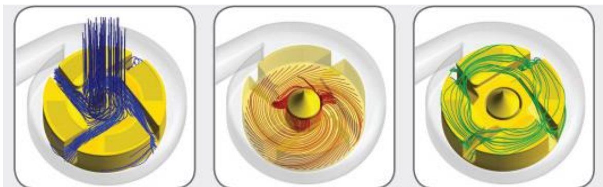
SLIKA 33. Kretanje protoka kroz pumpu, www.heartware.com
