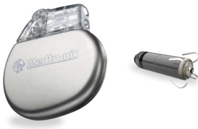
Slika 11. Konvencionalni dvokomorski elektrostimulator (lijevo) i Micra™ (desno). Preuzeto uz dopuštenje od (70)
