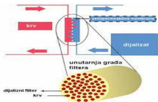
**Slika 13.** Prikaz funkcije dijalizatora. Preuzeto sa: [Što je dijaliza? / Dijaliza / Centri A-Z - Cybermed.hr](http://Sto-je-dijaliza?/Dijaliza/Centri-A-Z-Cybermed.hr)
