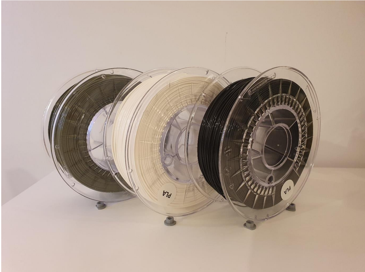
Slika 7. Prikaz PLA filameta korištenog u FDM uređaju za 3D tisak Prusa MK3S+.
