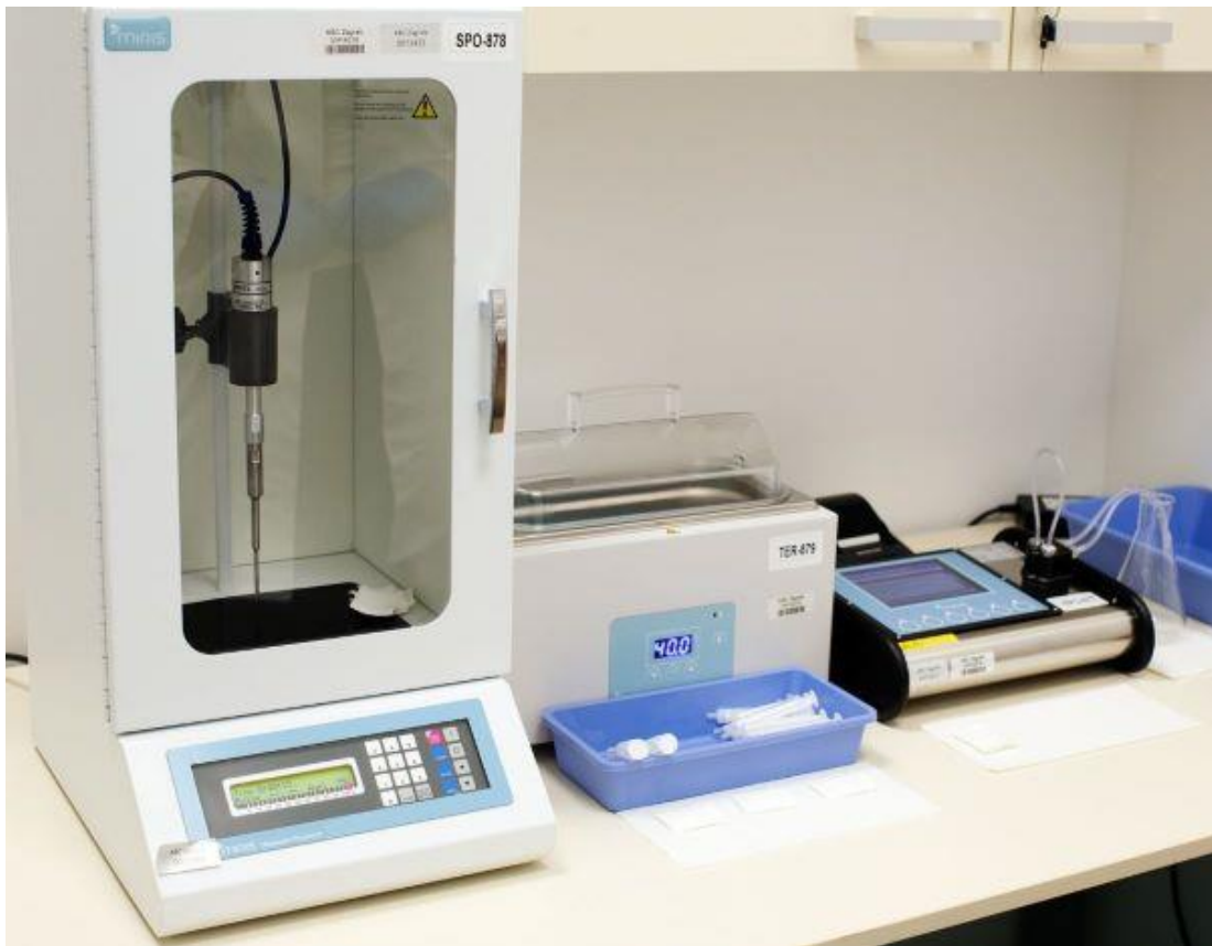
Slika 9. S lijeva na desno: Miris ultrazvučni procesor, kupelj s kuglicama za prijenos topline i analizator humanog mlijeka
