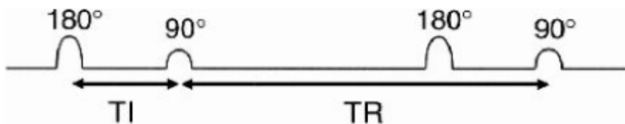
Slika 3.29. Grafički prikaz vremena inverzije (TI) i vremena ponavljanja (TR).Prema: Hashemi, Bradley, Lisanti (2003) MRI: The basics, str. 99.
