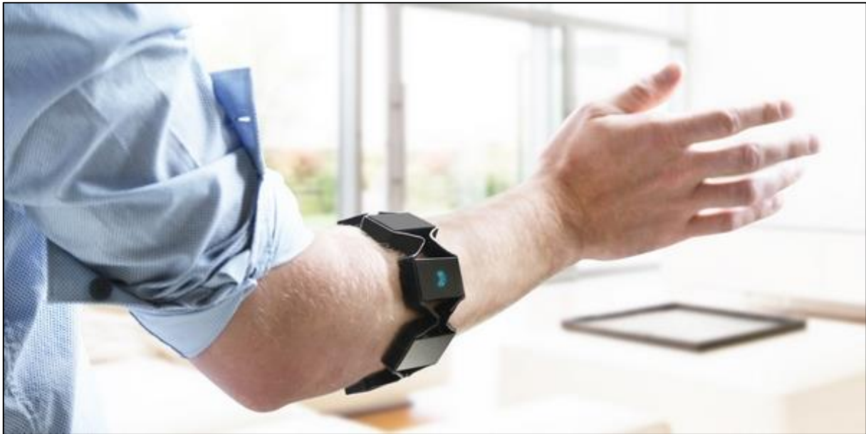
Slika 18 - MyoArmband SEMG uređaj postavljen na podlakticu. Prema: Huffington Post [Internet]. Detalji u poglavlju 9. (Korištene ilustracije).
