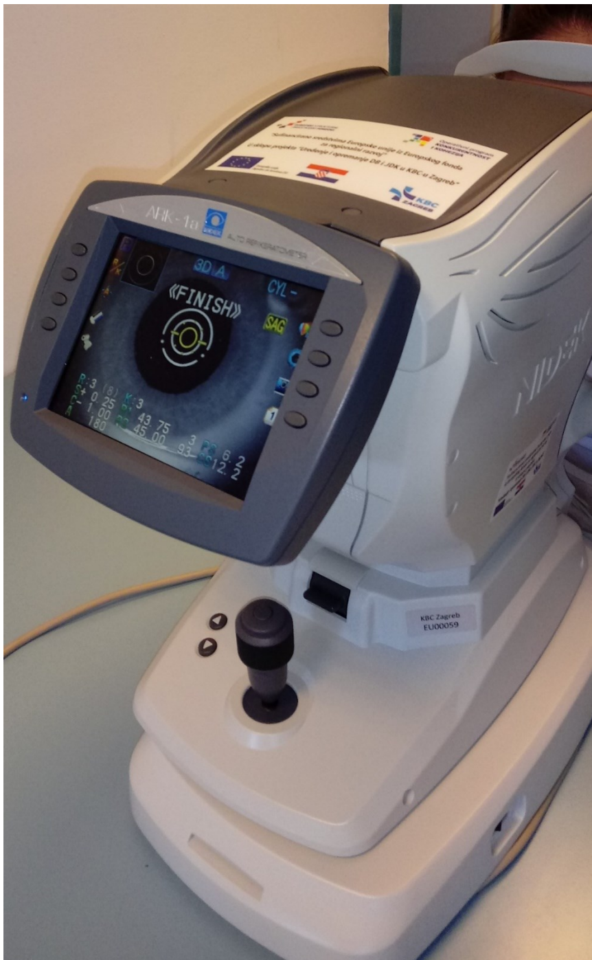
Slika 4. Za lakše određivanje vidne oštine koristi se automatski refraktometar (Nidek Auto Refractometer ARK 1a, Nidek CO. LTD. Japan).
