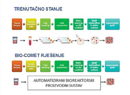
**Slika 1.** Trenutačno primjenjivana tehnologija zahtijeva dugotrajno, manualno uzgojanje tkiva u dvodimenzionalnim uvjetima. Projektom BIO-COMET svi koraci su zamijenjeni automatiziranim bioreaktorskim sustavom kojim se u konačnici dobiva zrelijе tkivo boljih bioloških i mehaničkih osobina.
