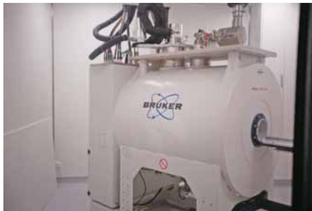
Uređaj za pretkliničko snimanje magnetskom rezonancijom malih životinja
