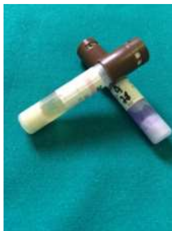
Slika 13-Pozitivna i negativna ampula brzih indikatora
