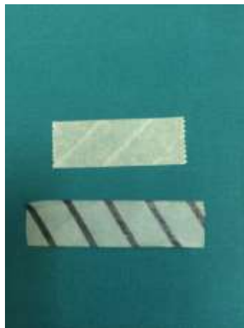
Slika 4-Klasa 1 kemijskih indikatora- ljepljiva traka
