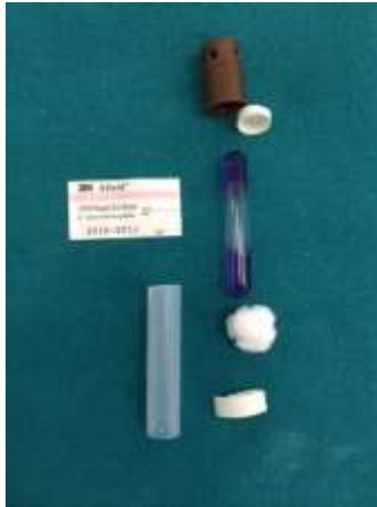
Slika 12-Sadržaj ampule brzog indikatora
