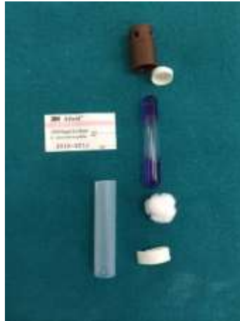
Slika 12-Sadržaj ampule brzog indikatora
