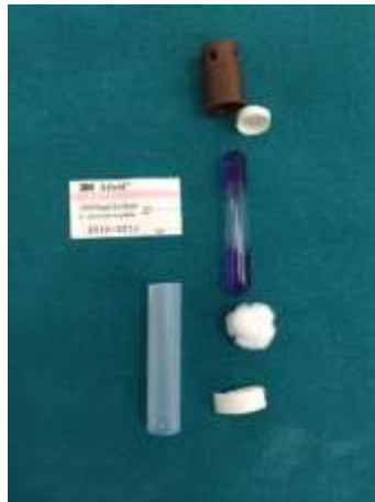
Slika 12-Sadržaj ampule brzog indikatora
