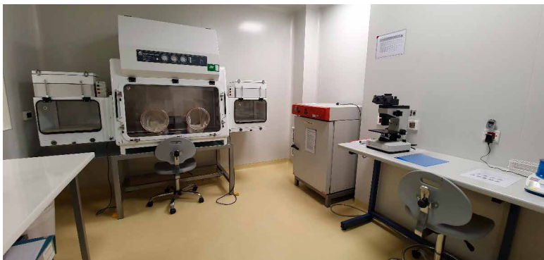
Slika 1. Laboratorij za staničnu kulturu, klasa D. Novopostavljeni izolator, inkubator te mikroskop služiti će kulturi stanica za proizvodnju rhBMP6.
