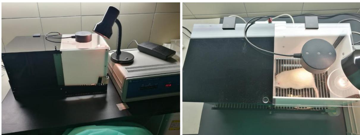
**Slika 10 Uredaj za izvođenje testa pasivnog izbjegavanja i provođenje testa u Pokusu 1.**
