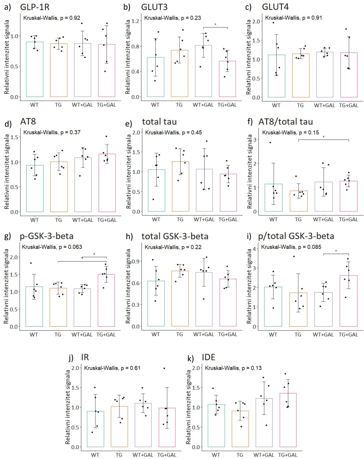
**Slika 54 Rezultati Western blot mjerjenja ekspresije proteina povezanih s inzulinskim sustavom, nosačima za glukozu, amiloidnom i tau patologijom te GLP-1 receptorom u hipokampusu miševa u Pokusu 3.**
