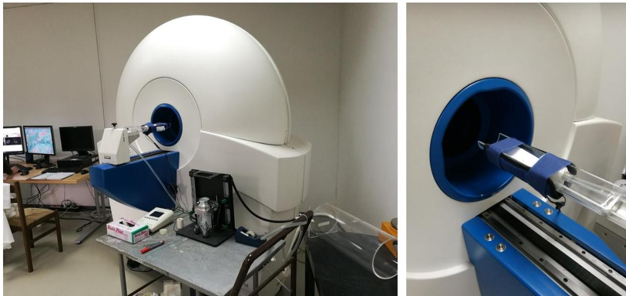
*Slika 14 Raytest ClearPET™ skener za male životinje Institutu Ruđer Bošković na kojem je provedeno in vivo mjerenje unosa  $^{18}\text{fluorodeoksiglukoze}$  u stanice mozga.*
