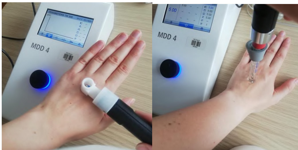
Slika 1. Komercijalni uređaj za mjerenje TEWL-a i pH kože korišten u istraživanju za potrebe Projekta*
