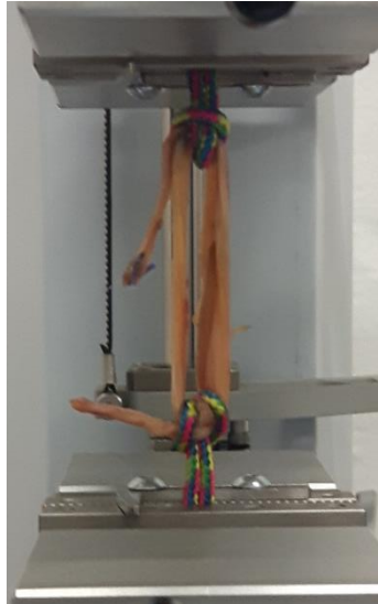
Slika 4.2. Prikaz pripremljenog presatka trostruke tetive ST-a i prihvat u samozatezajuću omču
