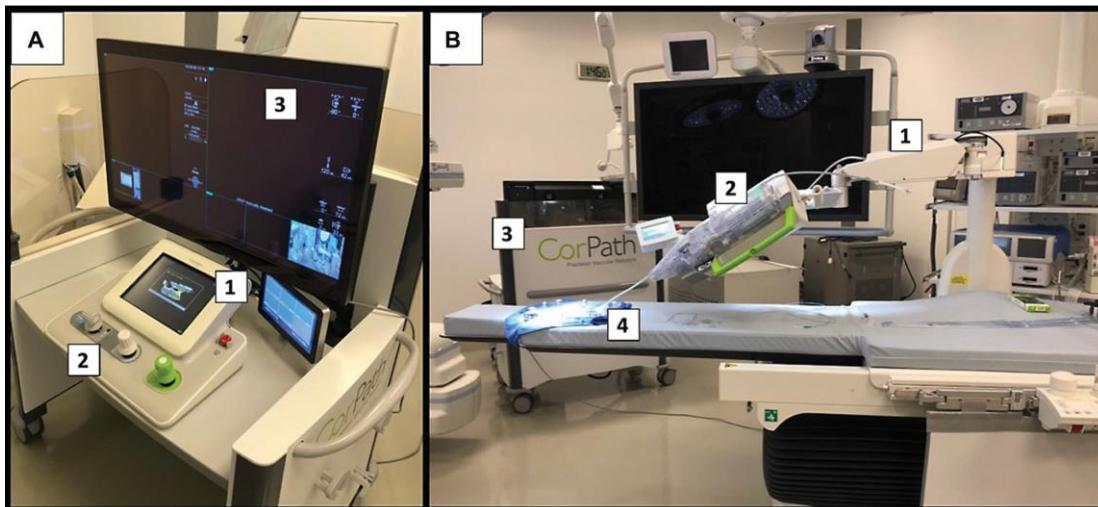
Slika 12. Prikaz sastavnih dijelova CorePath GRX robotskog sustava. Robot se sastoji od radne postaje (A i B3) i robotske jedinice (B). Na radnoj postaji nalaze se *touchscreen* kontrolni zaslon (A1), upravljačke ručice (A2) i monitor (A3). Robotsku jedinicu čine robotska ruka (B1) sa pripadajućim nastavkom i kateterom (B2). Prikazan je i stol na kojem se smješta pacijent za vrijeme zahvata (B4). Preuzeto iz: Britz, 202. (60) Uz dopuštenje Wolters Kluwer Health, Inc.
