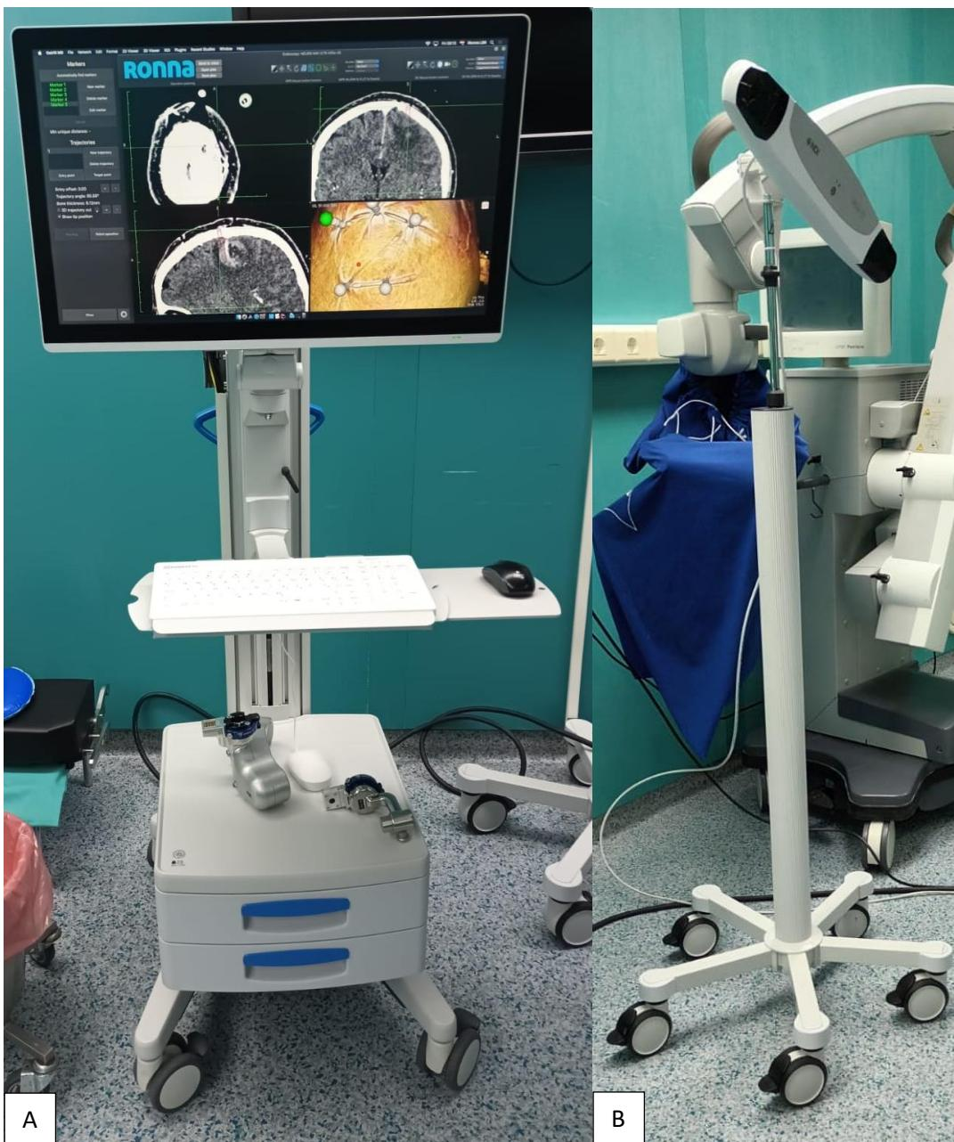
Slika 8. RONNA robotski sustav. A – postaja za planiranje trajektorije B – infracrvena stereo - kamera. (Privatna zbarka)
