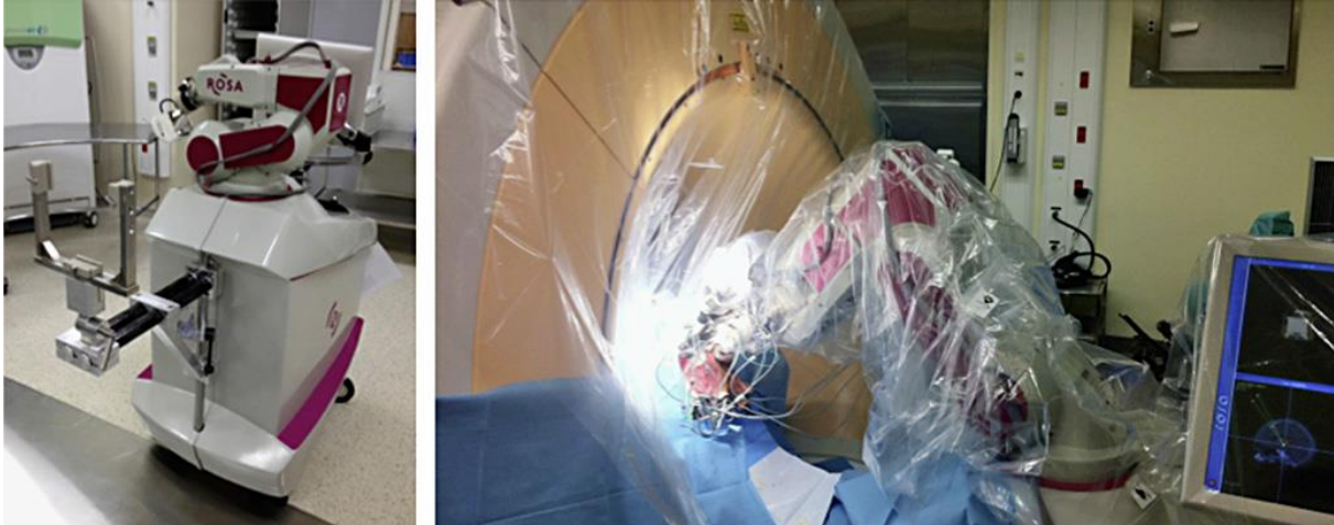
Slika 5. ROSA robotski sustav. Na lijevoj slici prikazan je izgled ROSA robotskog sustva. Na desnoj slici prikazana je primjena ROSA sustava za vrijeme operativnog zahvata uz intraoperativni CT. Preuzeto iz: Lefranc, 2014. (32) Uz dopuštenje Karger Publishers.
