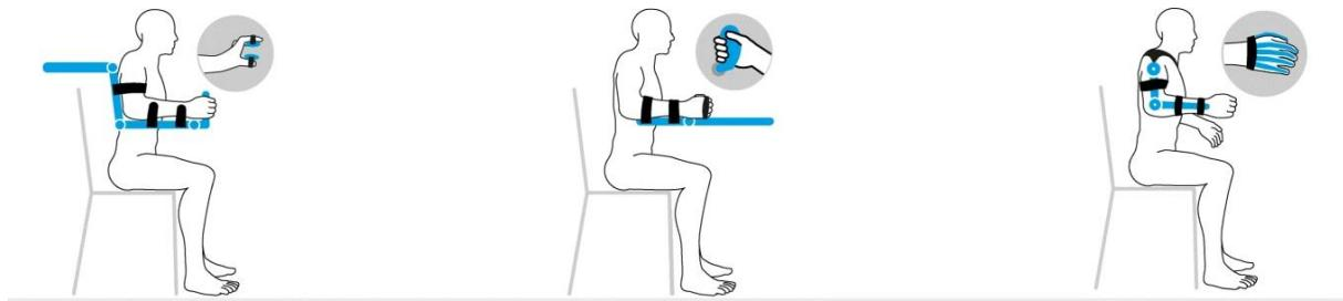
Slika 1. Lijevo – uzemljeni egzoskelet; sredina – uzemljeni uređaj s krajnjim efektom;
