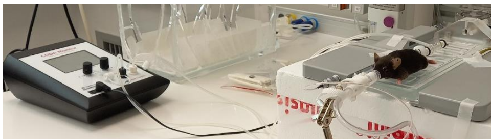
Slika 22. Sustav za neinvazivno mjerenje krvnog tlaka. Anestetizirani miš položen je na grijaču podlogu i na njušku mu je namještena inhalacijska maska. Manžetu za snimanje postavili smo na rep i spojili s mjernim uređajem za neinvazivno mjerenje krvnog tlaka.
