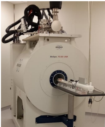
Slika 20. Uređaj za snimanje magnetnom rezonancom. Pretklinički Bruker Biospec 70/20 USR uređaj s magnetskim poljem snage 7 T za snimanje magnetnom rezonancom, smješten u Laboratoriju za regenerativnu neuroznanost Medicinskog fakulteta Sveučilišta u Zagrebu.
