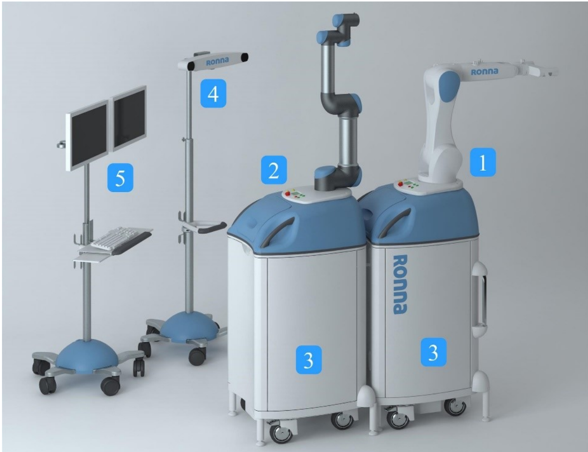
Slika 7. Kompletan robotski sustav RONNA G3. 1) Glavni robot, 2) robot asistent, 3) univerzalna pokretna platforma, 4) infracrvena kamera sa optičkim sustavom praćenja, 5) sučelje za planiranje operacije sa softverom
