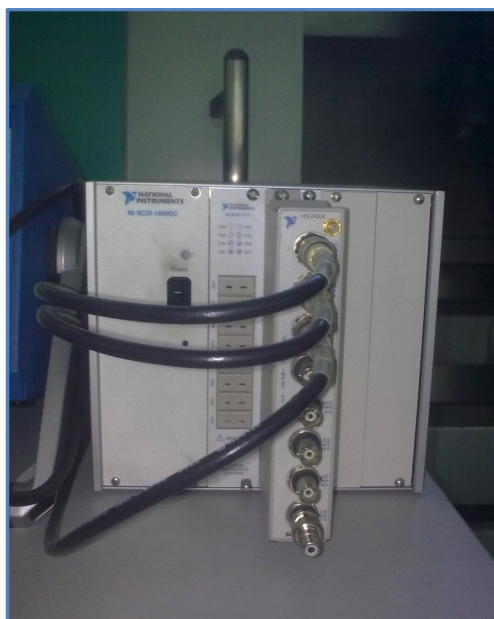
Slika 49. Mjerna stanica National Instruments NI SCXI-1000 DC
