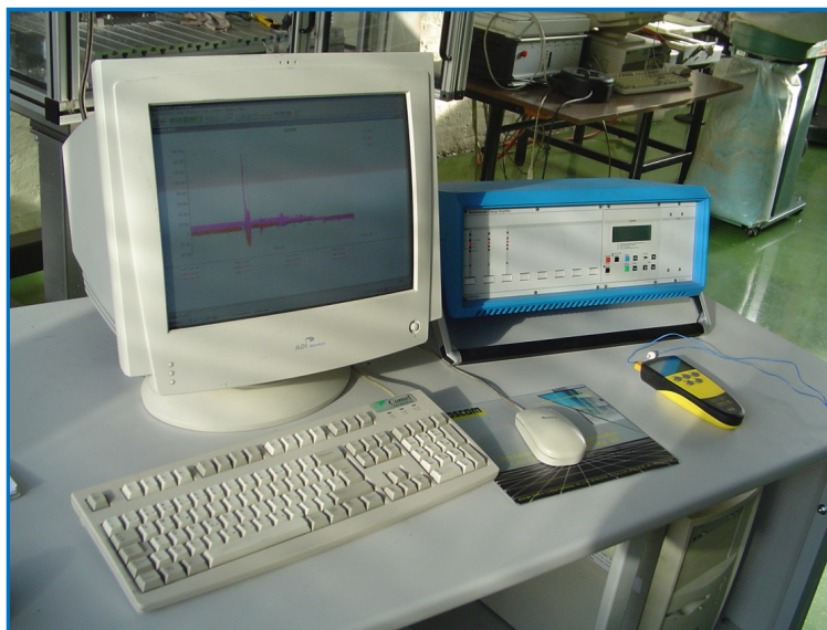
Slika 48. Uređaj za mjerenje sile Kistler 9257B
