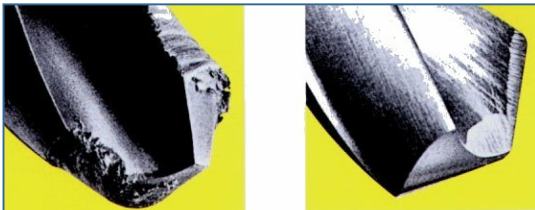
Slika 26. Oblici istrošenja svrdla
