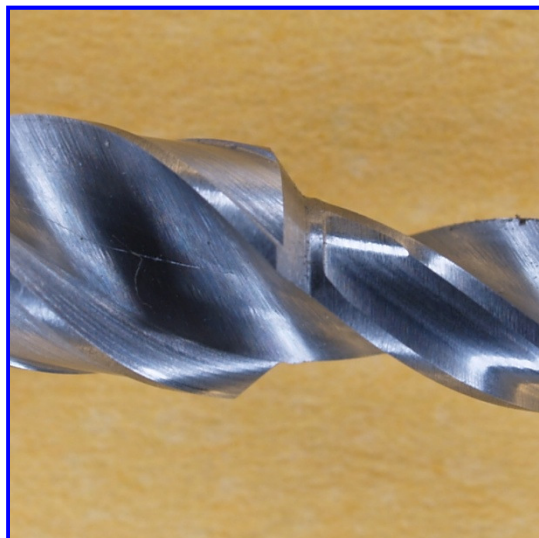
Slika 64. Oštrica drugog stupnja dvostupnjevanog spiralnog svrdla promjera 3.4-4.5 mm prije mjerenja
