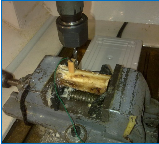
Slika 47. Prikaz dijafize kosti u steznom škripcu sa termoparom 0.5mm od mjesta bušenja
