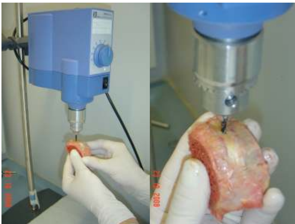
Slika 3.11. Postupak formiranja otvora na fibroznom prstenu prije izvođenja pokusa ultrazvučnom sondom.
