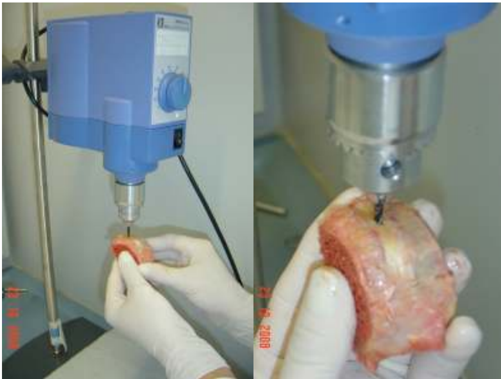
Slika 3.11. Postupak formiranja otvora na fibroznom prstenu prije izvođenja pokusa ultrazvučnom sondom.
