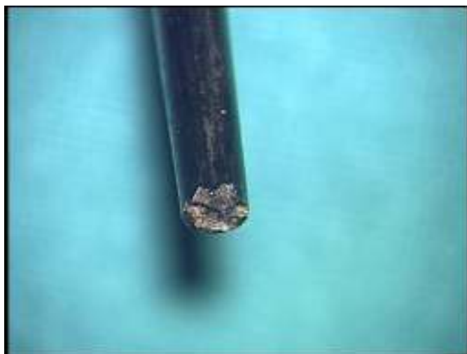
Slika 5.1. Vrh upotrijebljene ultrazvučne kontaktne sonde načinjen od titansko-aluminijske legure, oštećen utjecajem kavitacije.
