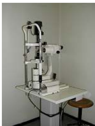
Slika 2. Biomikroskop NS-1 tvrtke Nikon sa dodatkom za aplanacionu tonometriju
