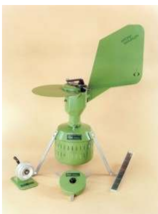
Slika 6. Sedmodnevni kontinuirani uzorkivač za pelud i spore Hirst-ovog tipa (proizvođač: Burkard, UK)
