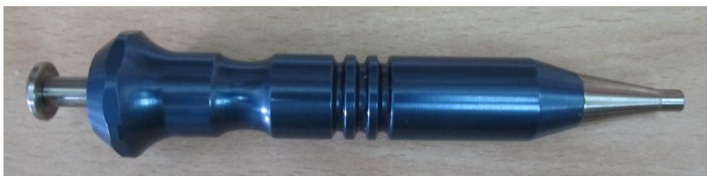
Slika 8. Specijalna šuplja igla kojom su se uzimali uzorci od 5 mm za TMA
