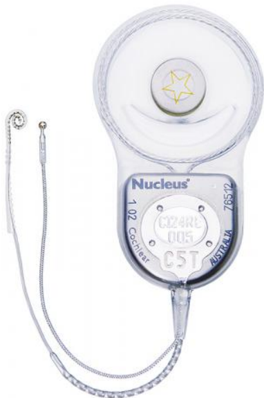
Slika 2. Nucleus Freedom CI24RE s Contour Advance elektrodom (preformirana elektroda koja već ima oblik pužnice). Druga elektroda koja završava s kuglicom je referentna elektroda. Okrugli dio sa zvijezdicom je magnet koji drži vanjsku antenu na mjestu. Po obodu kruga oko magneta vidi se unutrašnja antena. Photo provided courtesy of Cochlear™ Americas, © 2009 Cochlear Americas
