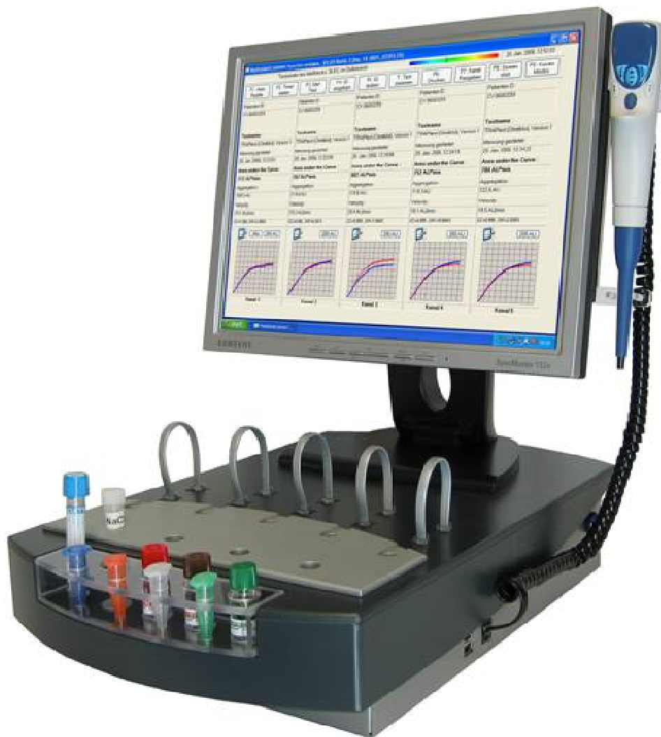
Slika 2. Uređaj impedancijske agregometrije uzorka pune krvi
