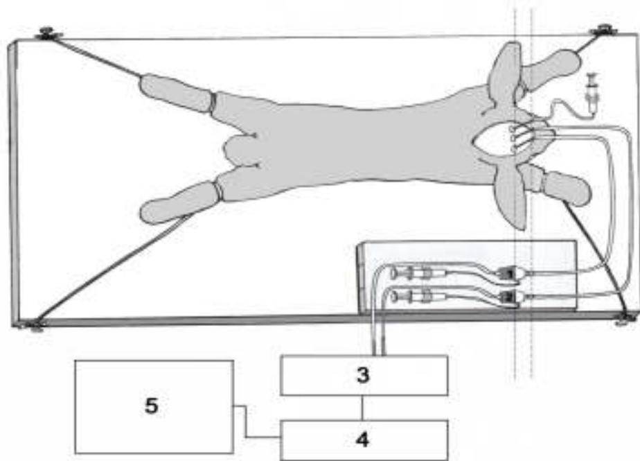
**Slika 3.5.** Shema eksperimentalnog modela kunića. **1** - pretvarač tlaka spojen na mjernu kanilu u lateralnoj komori, **2** - pretvarač tlaka spojen na mjernu kanilu u kortikalnom subarahnoidnom prostoru, **3** - Quad Bridge, **4** - PowerLab/800, AD Instruments, Castle Hill, NSW, Australia, **5** - računalo.
