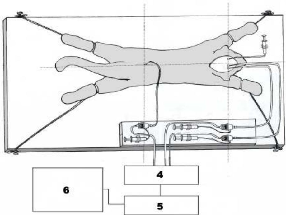
**Slika 3.3.** Shema eksperimentalnog modela mačke. Životinja je fiksirana na ravnu ploču, kao i pretvarači tlaka i mjerne kanile. **1** – pretvarač tlaka spojen sa mjernom kanilom u lateranoj komori, **2** – pretvarač tlaka spojen sa mjernom kanilom u kortikalnom subarahnoidnom prostoru, **3** – pretvarač tlaka spojen sa mjernom kanilom u lumbalnom subarahnoidnom prostoru. **4** – Quad Bridge, **5** – PowerLab/800, AD Instruments, Castle Hill, NSW, Australia, **6** – računalo.
