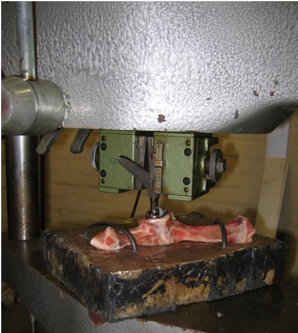
Slika 22. Zdjelica postavljena na univerzalnoj kidalici.
