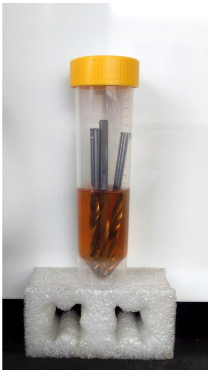
Slika 39. Svrkla s kanalom za protočno hlađenje uronjena u tekuću hranjivu podlogu BHI (Brain Heart Infusion Broth, Oxoid) na koju su ranije naciepljeni sojevi bakterija Pseudomonas aeruginosa , Bacillus spp. Streptococcus spp. beta-hem., Enterobacter spp. i Staphylococcus pseudintermedius methicillin-resistant (MRSP)
