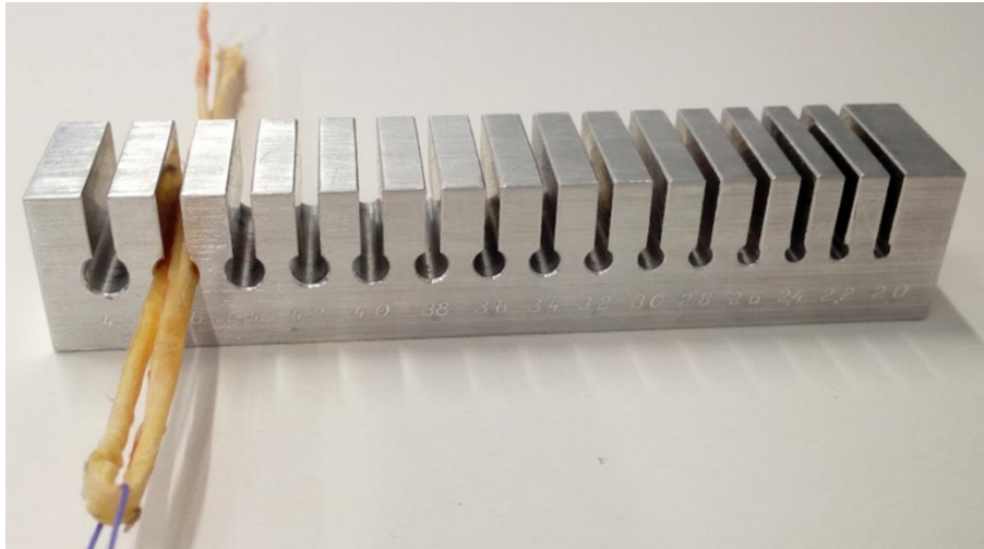
Slika 4.1. Fotografija metalnog instrumenta za određivanje promjera presatka tetive i dvostruko presavijene tetive mišića gracilisa postavljene kroz otvor promjera 4,6 mm.
