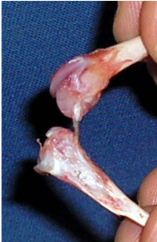
Slika 7. Preparat kost-ligament-kost (femur-medijalni kolateralni ligament-tibija) koji je načinjen za potrebe biomehaničkog testiranja. Fotografija je snimljena pomoću digitalnog fotoaparata Canon DIGITAL IXUS II.
